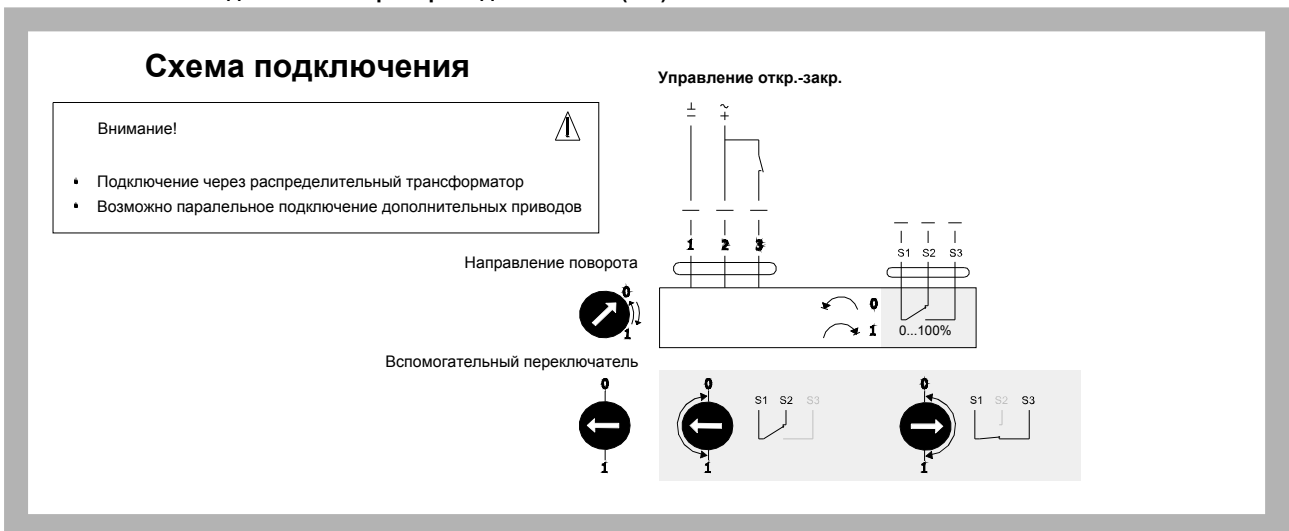
Рис. 12. Схема подключения сервопривода Belimo LM(NM) 24A-S
