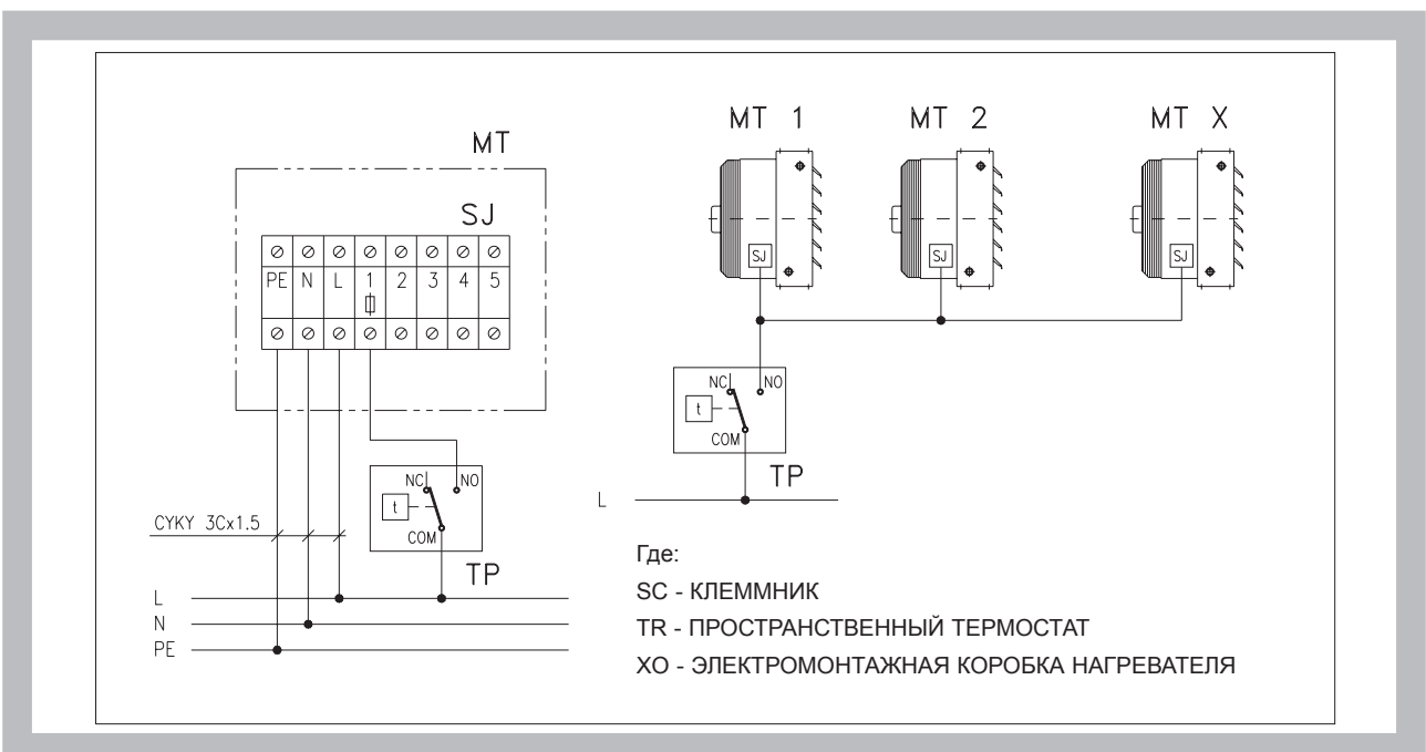
Рис. 18: Схема включения простр. термостата для регулирования водогрейного нагревателя
