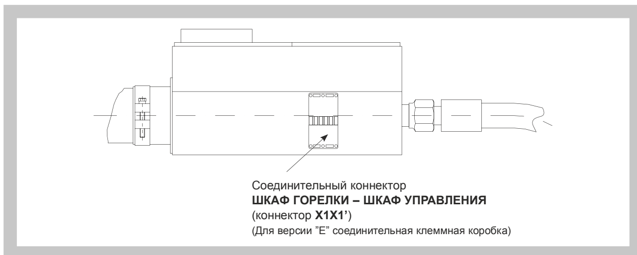
Рис. 32. Точки присоединения электроустановки инфраизлучателя HELIOS 33S, 50S.
