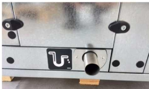
Отвод конденсата холодильника
