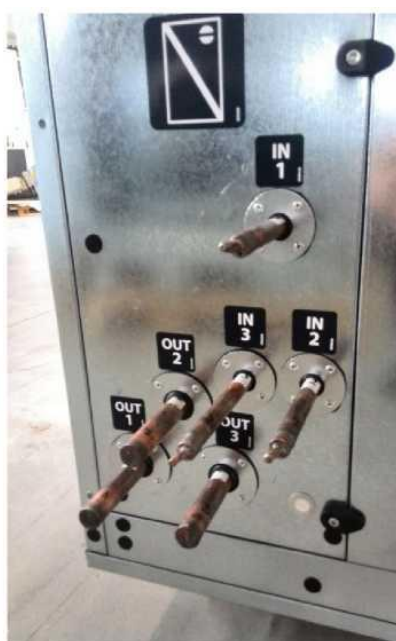
Пример обозначения 3-контурного испарителя.
