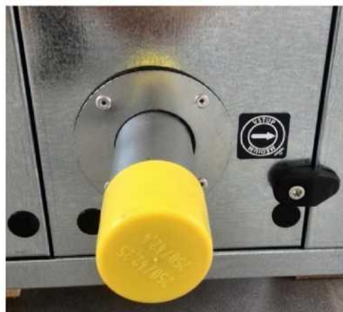
Обозначение выпуска из теплообменника.
