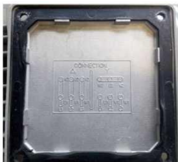
Крышка клеммной колодки со схемой подключения
