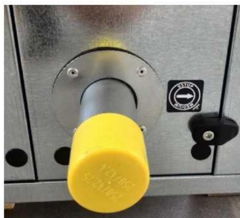
Обозначение выпуска из теплообменника.
