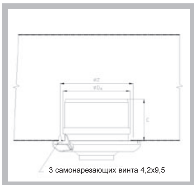
Регулируемое сопло с ручной регулировкой DDM II/N установленное в стену четырехгранного трубопровода
