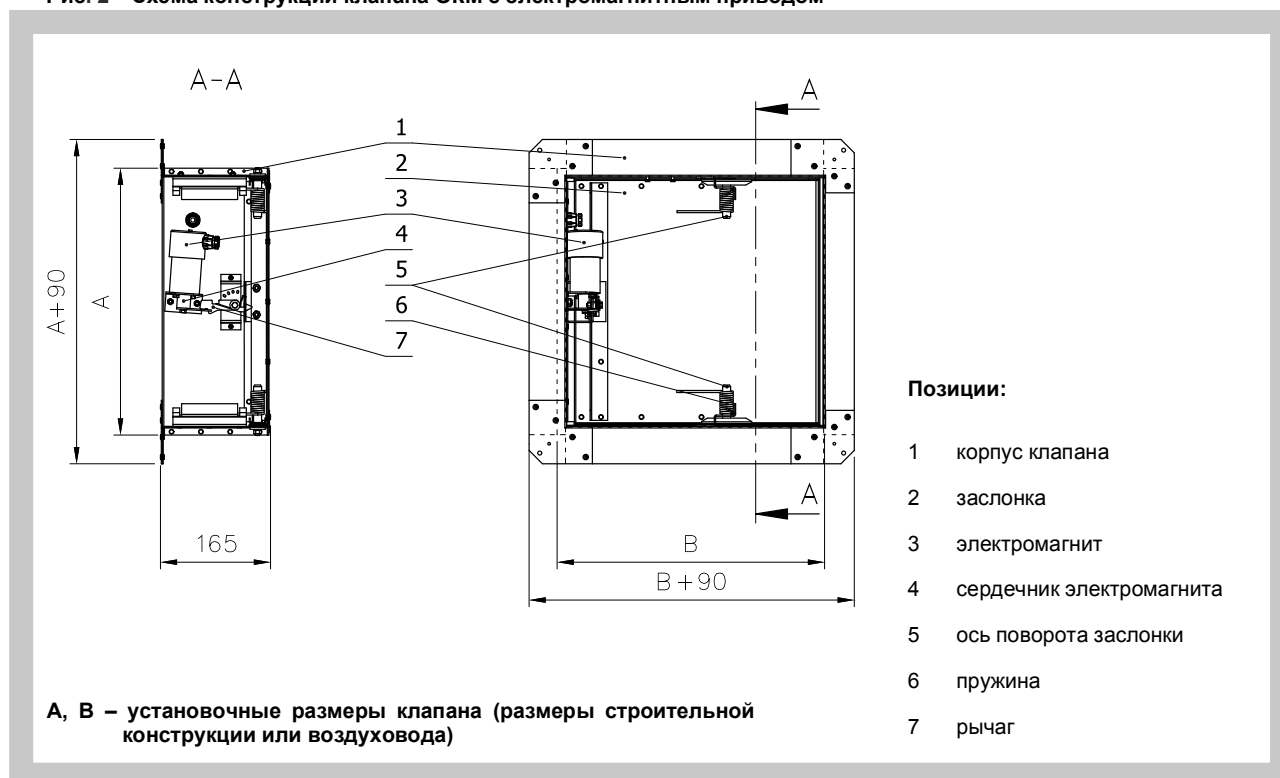
Рис. 2 Схема конструкции клапана ОКМ с электромагнитным приводом
