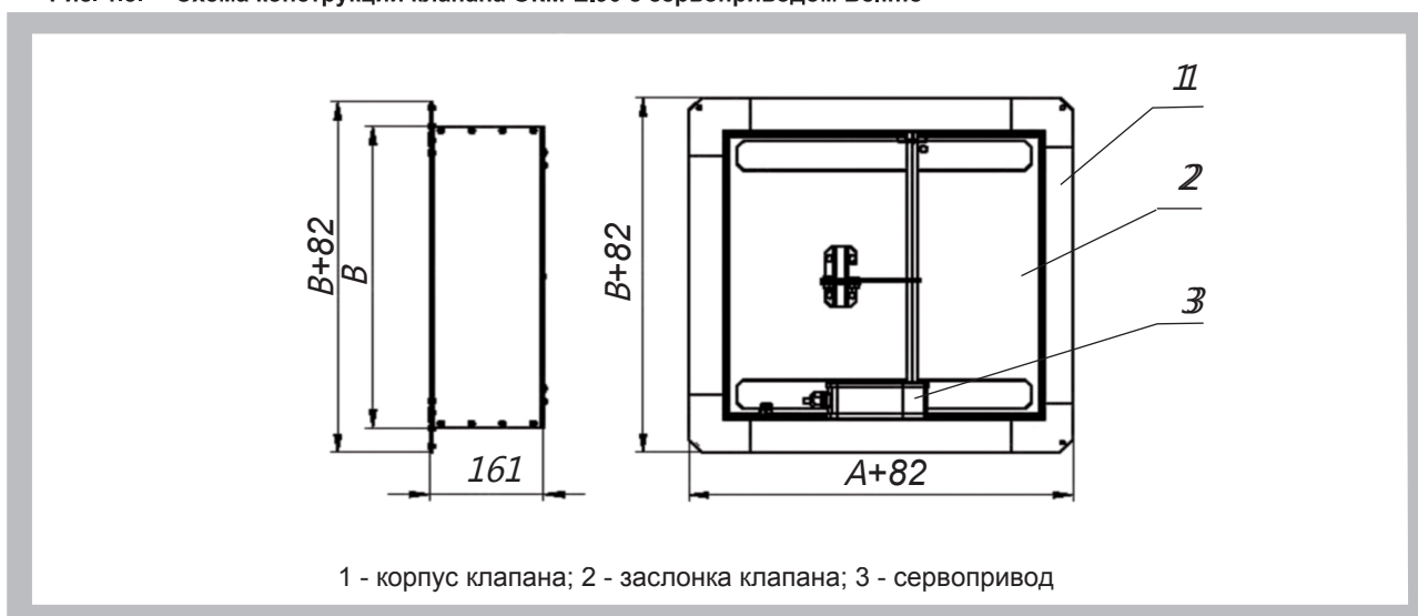
Рис. 1.3. Схема конструкции клапана ОКМ-ЕI90 с сервоприводом Belimo
