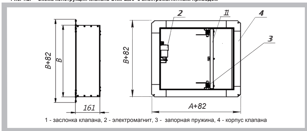
Рис. 1.2. Схема конструкции клапана ОКМ-ЕI90 с электромагнитным приводом
